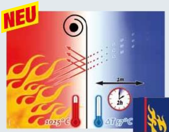
Nach 2 Std. nur 57° C in einem Abstand von 1 Meter (schematische Darstellung EW120)
