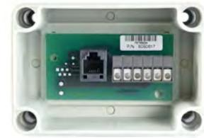
Adapterplatine im Gehäuse IP66
