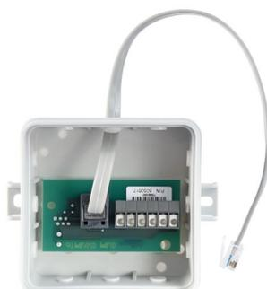
Platine d'adaptation dans un boîtier IP55
